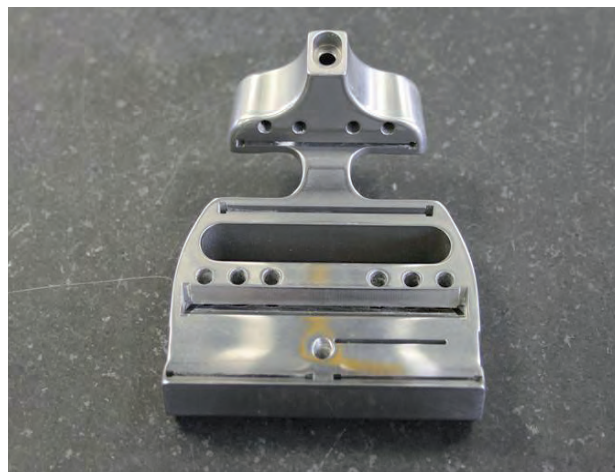
» Découpe spéciale pour équipement médical usinée par étincelage par SPEMA
