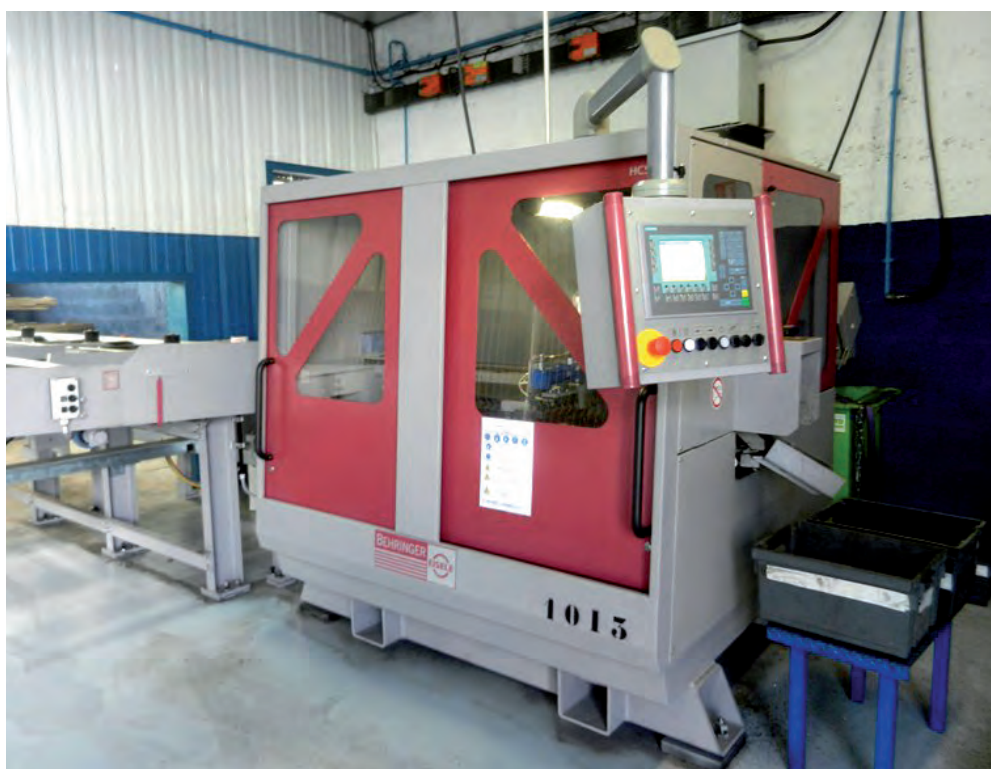
» Behringer Eisele Fraise scie de grand rendement, la HCS 70 est une machine à utiliser pour les petites aux grandes séries de production, de 50 à 30 000 unités par mois.
