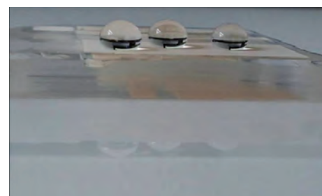
» Surface rendue hydrophobe par texturation laser.
