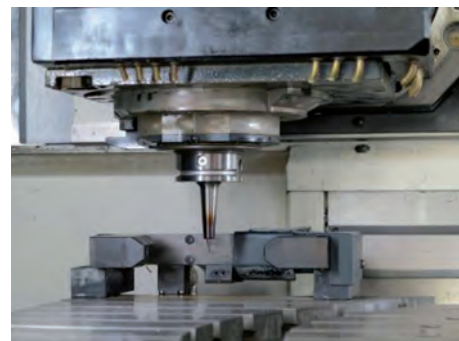
» Même les outils les plus petits sont mesurés en quelques secondes seulement grâce au système de mesure laser Blum précis.
