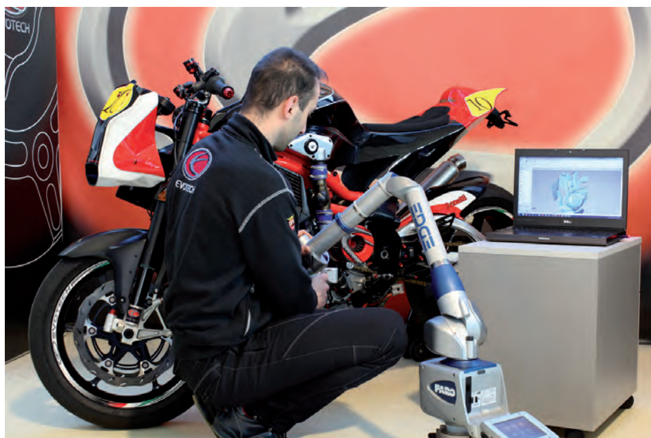
» Prise de cotes avec le Faro Edge ScanArm, par un technicien spécialisé d'Evotech.
