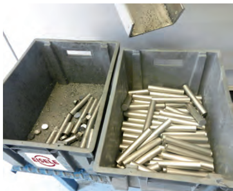
» Des tronçons conçus pour le corps humain : le titane, sectionné à la scie circulaire HCS 70, est utilisé pour des implants médicaux.
