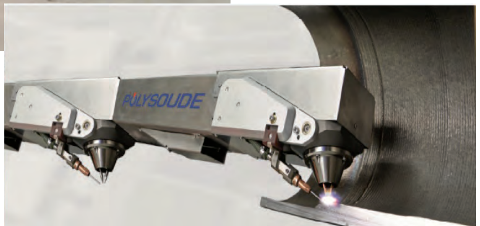
Banc de soudage de 12 mètres pour le rechargement horizontal TWIN-TIGer conçu par Polysoude SAS France
