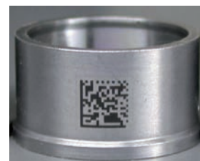
» Code datamatrix gravé sur une pièce cylindrique en acier
