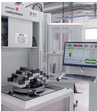
» Une même palette quelle que soit la machine et une station de pilotage du flux pièces
