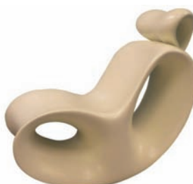
» Figure 4 : Maquette fauteuil d'avion - EAD Aerospace - Mousse PU
