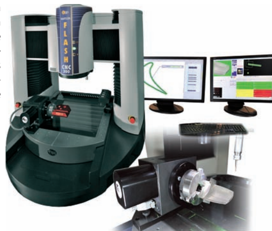
» SMARTSCOPE FLASHCNC300 équipe le 4 e axe pour la mesure de pales creuses
