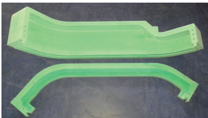
► Figure 6 : Outillage Rapide pour drapage sous pression - Equip Aero Technique - Résine Epoxy
