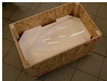
► Figure 9 : Ogive Transparente - Strato Altuglas CIRTES et emballage EPS - Équipementier de Dassault Aviation
