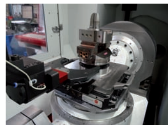
» Un référentiel de positionnement simple adaptable sur toute machine, avec ou sans robot
