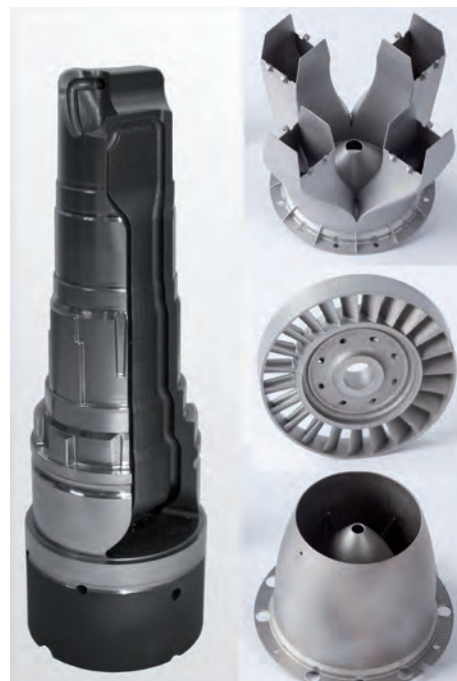
► Pièces fusion laser et reprises 5 axes
