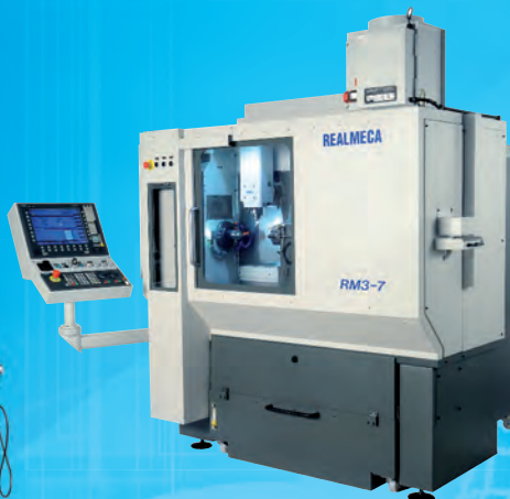
Centre multifonction de super précision REALMECA RM3-7 Usinage à partir de barre de pièces de micromécanique
