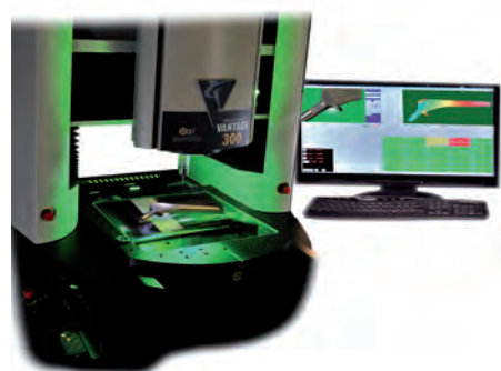
» Contrôle par scanning Laser TTL d'une prothèse de anche sur SmartScope Vantage
