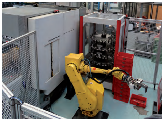
» Robot polyarticulé Erowa - dressage des ébauches
