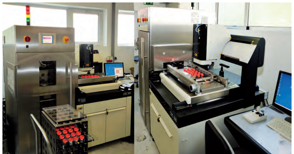
» Contrôle entièrement automatisé de bouchons à usage médical autour d'un SmartScope CNC500
