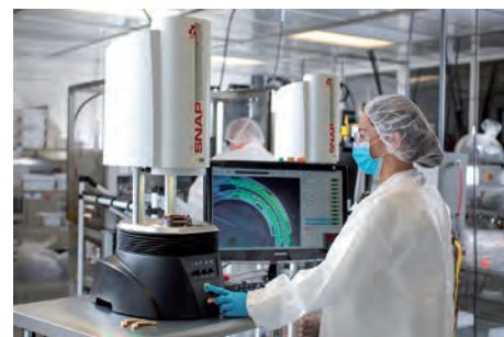
» Contrôle en libre-service de pièces pour stimulateur cardiaque avec une machine Snap à large champ vidéo
