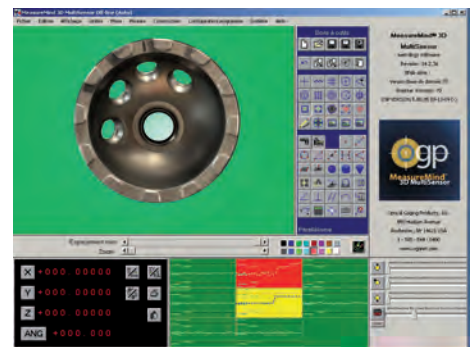
» Contrôle de vis avec dépôt antibactérien avec un laser TTL 4ème axe et sonde contact TP200
