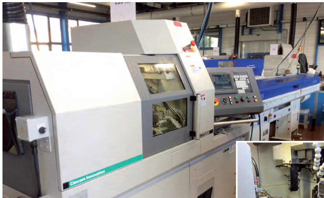
» La dernière machine entrée dans l'atelier de la gamme L20-XII avec axe B pour le travail en broche 1 et en broche 2
