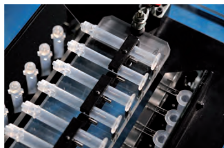
» Contrôle de seringues avec miroir de renvoi à 45 deg. étalonnés
