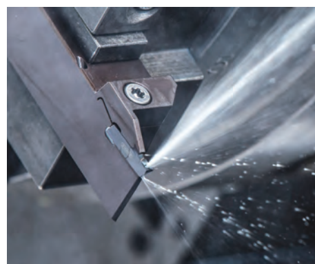
» Refroidissement sur la plaquette deux arêtes qui agit directement sur la zone de coupe
