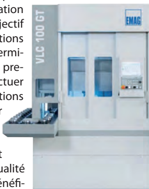
» Que ce soit pour le tournage ou la rectification, le VLC 100 GT offre la possibilité d'utiliser presque toutes les techniques d'usinage.
