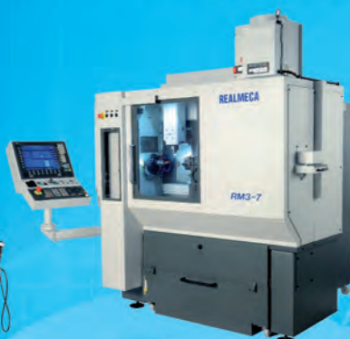
Centre multifonction de super précision REALMECA RM3-7 Usinage à partir de barre de pièces de micromécanique
