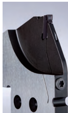
» Cassette 845 avec refroidissement intérieur via le doigt de serrage et par le bas
