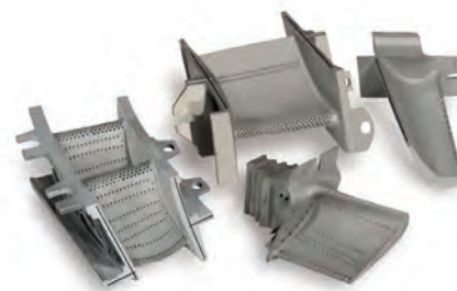
» Photo 6 : Ces pièces « de moteurs haute température » pour turboréacteurs illustrent la configuration de plus en plus complexe des trous de chambre de combustion, à réaliser dans de multiples formes et dans des diamètres réduits.
