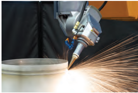
» Photo 7 : Perçage à grande vitesse, à la volée de pièces d'un turboréacteur à l'aide du système de programmation de LASERDYNE de conception exclusive avec les fonctions OFC (contrôle de focalisation du faisceau optique), BTD (système de détection de perçage) et CylPerf pour l'usinage à angles faibles et composés.
