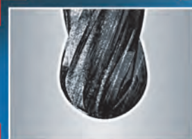
Inspection d'outil par éclairage frontal
