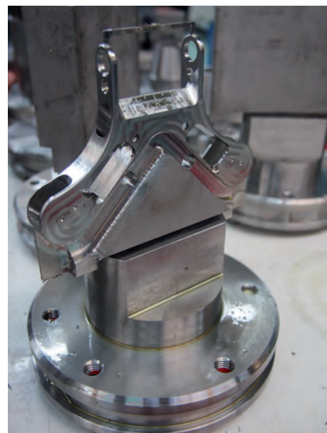
» Pièces pour l'instrumentation médicale ; beaucoup sont impossibles à réaliser sans un centre 5 axes
