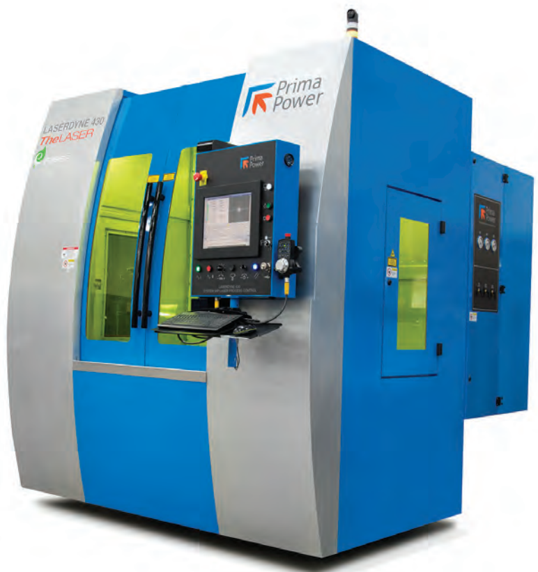
» Photo 10 : Système LASERDYNE 430BD à six axes conçu pour la découpe, le perçage et le soudage de pièces en 2D et 3D grâce à un laser à fibre optique en mode OCW jusqu'à 20 kW.
