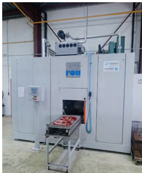
» L'an dernier, la société a investi dans une machine haut de gamme de lavage et de dégraissage de marque Roll
