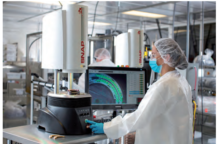
» Mesure en salle blanche de composants pour stimulateurs cardiaques sur OGP Snap
