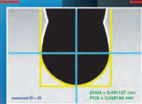
Mesure d'outils par ombroscopie
