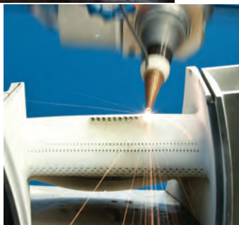
» Photos 8 et 9 : La conception et la réalisation des trous de refroidissement sont vitales pour le rendement des moteurs destinés à l'industrie aéronautique. Les moteurs de nouvelle génération exigent une plus forte densité de trous de refroidissement et la réalisation de trous plus complexes. Ces trous sont de très faible diamètre – entre 0,5 et 0,75 mm – et réalisés à angles aigus par rapport à la surface de la pièce. Les systèmes laser de nouvelle génération sont les seuls capables de réaliser ces profils de trous de façon efficace et à moindre coût.
