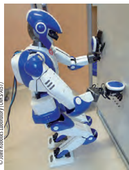
» La planification et le contrôle des mouvements multi-contacts de robots humanoïdes
