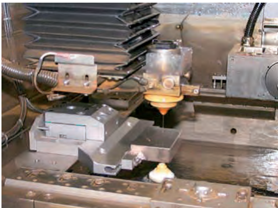
» Avec cet étai H4260 Hirschmann les buses peuvent être au plus près et le dessous de la pièce est au niveau zéro de la machine
