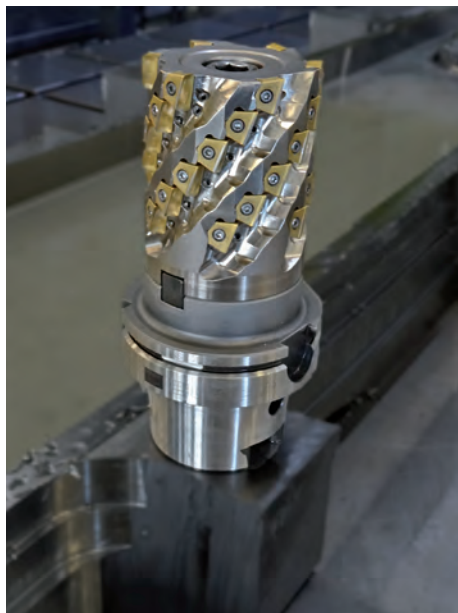
» Conçue pour l'aéronautique, la VFX5 est une fraise d'ébauche à fort débit de copeaux offrant la douceur d'un usinage sans vibration
