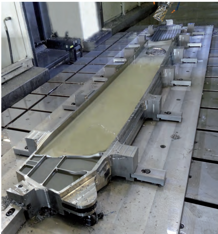
» Le zéro défaut dès la première pièce ne s'improvise pas quand il s'agit d'enlever près de 1 000 kg de titane
