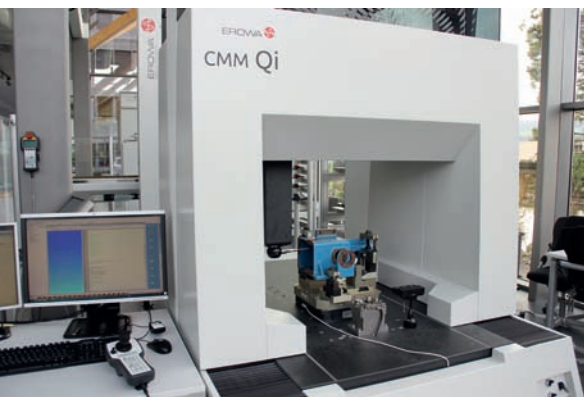
» CMM Qi-Erowa fait de la mesure 3D automatisée en production-un outil qui convient pour mettre en œuvre du contrôle adaptatif
