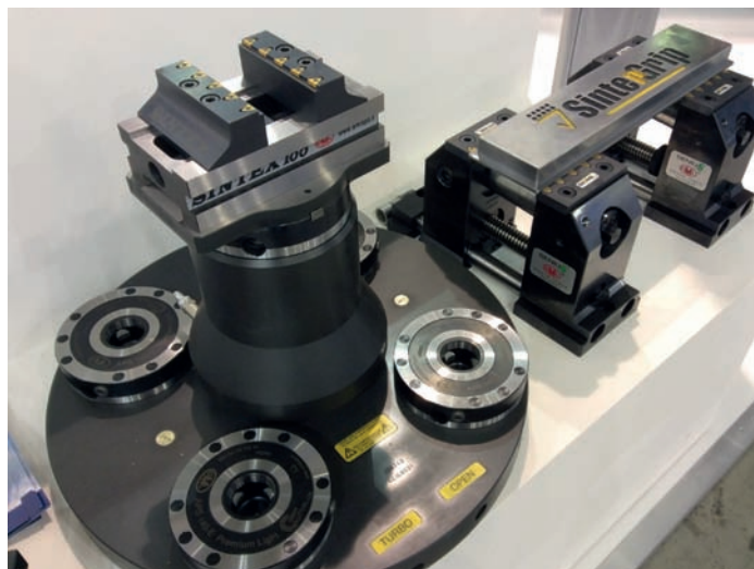
► Solution de palettisation pour C.U. 5 axes Point Zéro APS (Automatic Positioning System)
