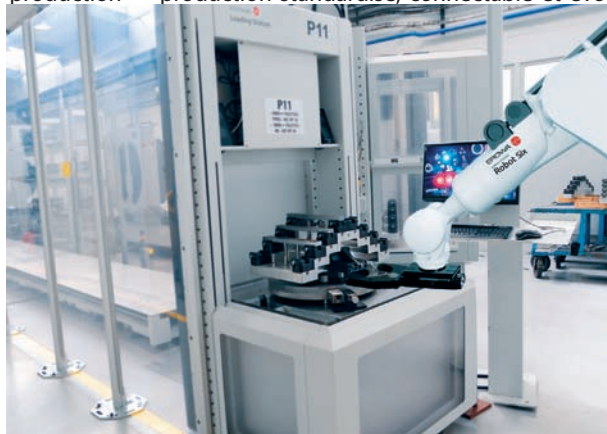
» RobotSix complète la gamme des robots Erowa pour l'automatisation du chargement machines et la gestion des flux pièces du brut jusqu'à l'expédition
