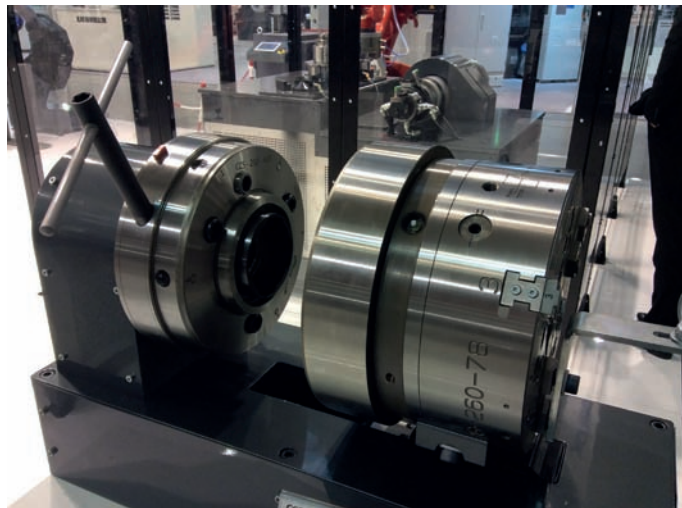
► Système de changement rapide de mandrin CCS pour tour CN
