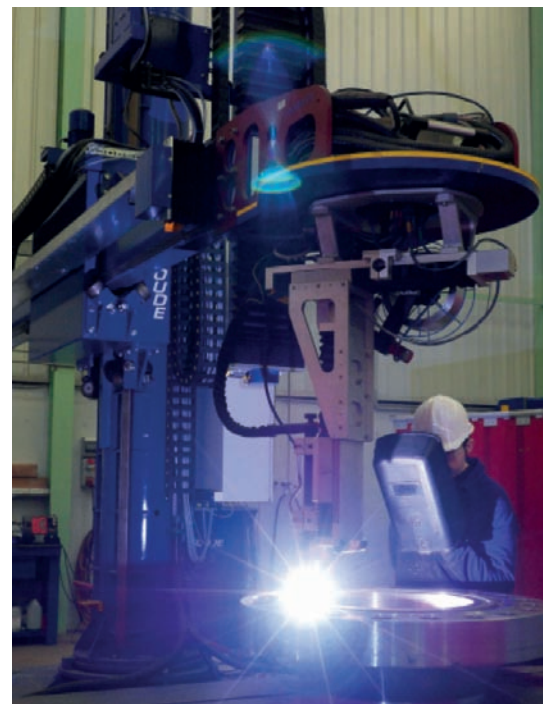
► Tête de soudage à collecteur TIGer tournant (© Polysoude)
