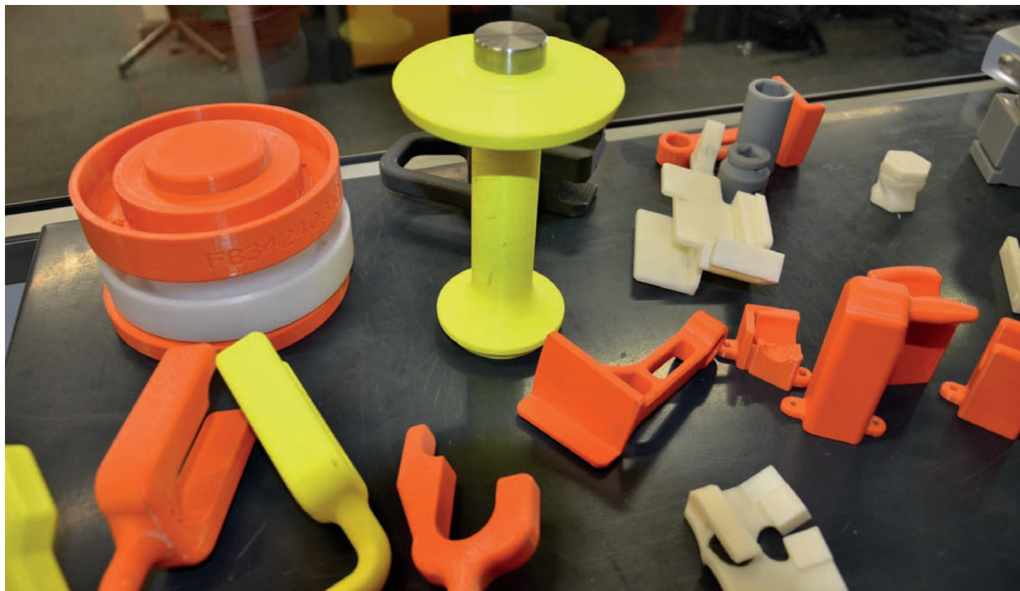
» Grâce à la technologie de fabrication additive de Stratasys, Volvo Trucks a ramené de 36 à 2 jours les délais d'exécution de plusieurs fixations, gabarits et supports
