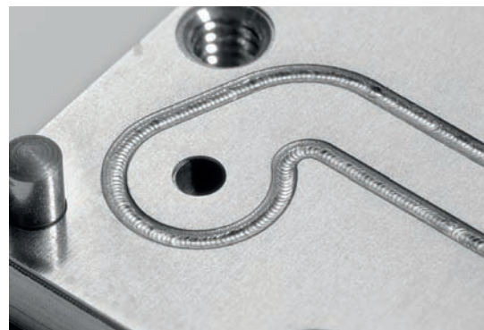
» Exemple de cordon de soudure par laser
