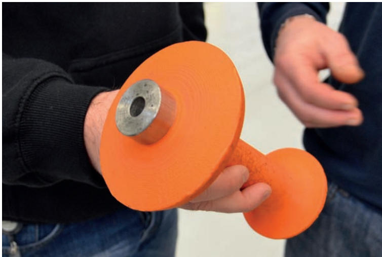
» Ce support de tuyau imprimé en 3D (en gris) est utilisé pour maintenir en position un tuyau du moteur pendant son montage par l'opérateur de la ligne de production
