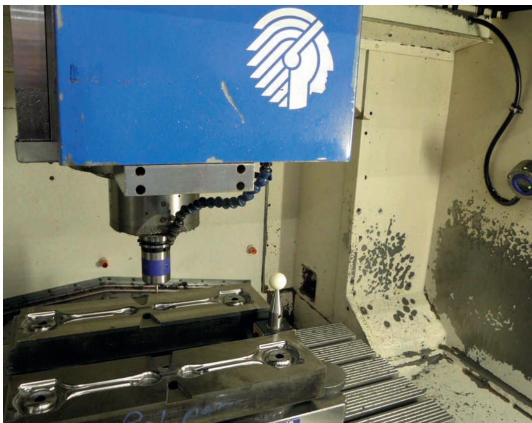
► L'usine PSA de Mulhouse travaille sur 6 machines Huron équipées de palpeur m&h
