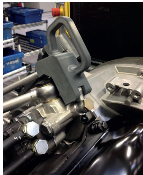
» Cet outil de poinçonnage durable et léger fait partie des outils de la chaîne de montage produits par Volvo Trucks avec la technologie d'impression 3D FDM de Stratasys
