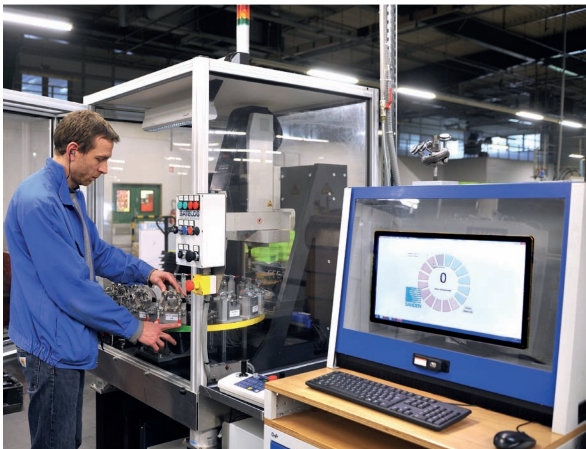
» Chargement des pièces et représentation graphique du carrousel
