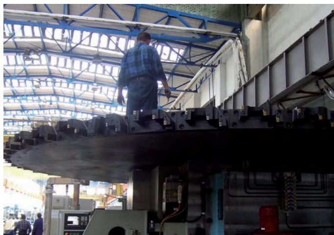
» Fraiseuse circulaire extérieure, diamètre 6 500 mm, pour vilebrequins de moteurs diesel de navires
