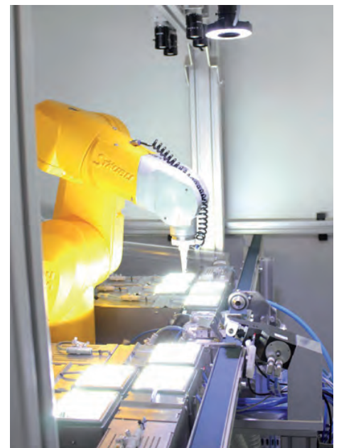
⌚ Compact, le robot TX40 réussit à manipuler des dents synthétiques avec précision, vitesse et fiabilité
