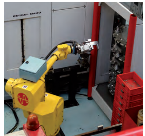
⌚ Cellule autonome alimentée par un robot polyarticulé
