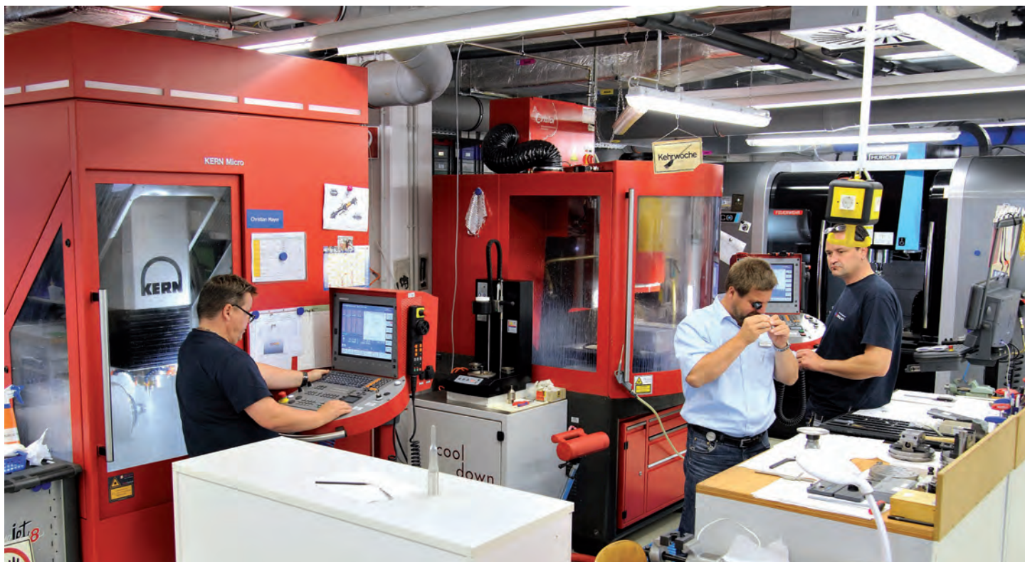
🕒 Avec la Kern Micro, Admedes Schuessler peut profiter d'un vrai usinage à 5 axes et fraiser des pièces pouvant aller jusqu'à des dimensions de 350 x 220mm.
