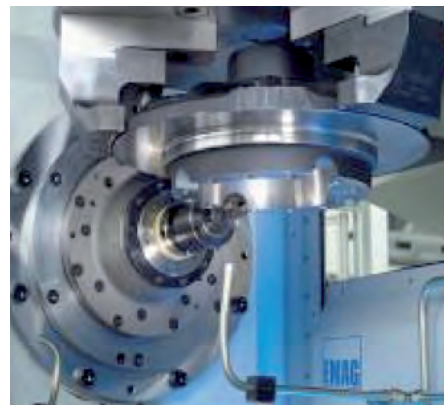
Ⓢ Intégration de processus complet sur une seule machine : tournage, perçage, fraisage, meulage et ébavurage
