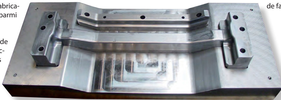
⌚ Outillage d'emboutissage prototype d'une traverse servant à former des renforts de tablier pour l'automobile
