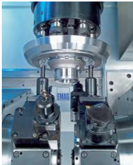
④ La broche de travail avec la pièce se déplace sur les axes principaux X et Z, et facultativement sur l'axe Y
