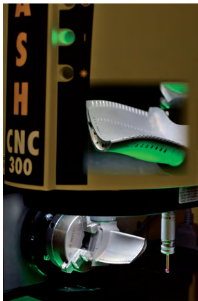
⬆ Mesure de pale sur SmartScope
