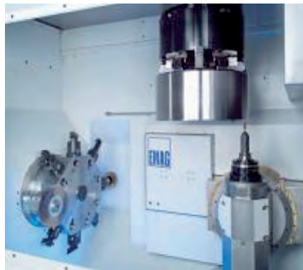
④ Usinage complet avec tourelle-revolver, broche de perçage sur une unité d'axe Y-B supplémentaire et magasin d'outils.
