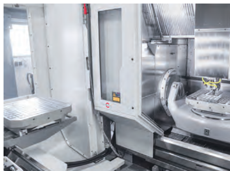
⬆ Zone de travail du centre d'usinage 5 axes compact C 42 UP avec la table circulaire pivotante CN 800 x 630 mm pour la fixation de différentes palettes équipées ; à gauche, une palette posée sur le poste de magasin
