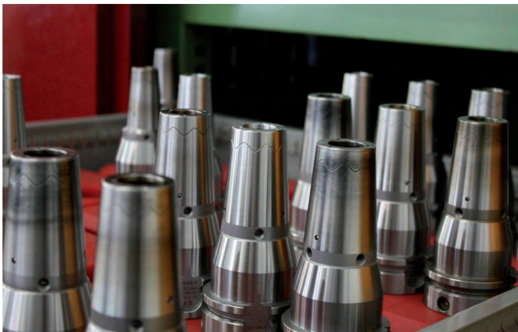
» Les Power Shrink Chucks de Haimer sont utilisés lors d'opérations d'ébauche et de finition exigeantes chez – © Haimer
