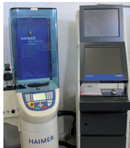
» A proximité des bancs de frettage, se trouve une équilibreuse Haimer Tool Dynamic Preset, une solution combinée pour l'équilibrage et la mesure pour porte-outil et outil
