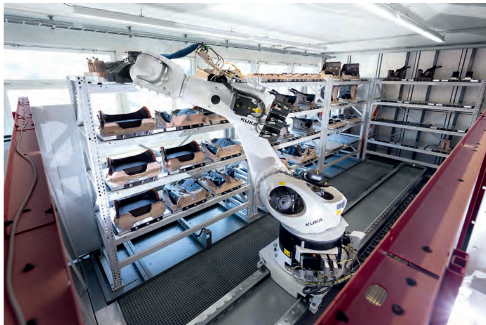
» Système de robot et de magasin de pièces RS 3 avec l'axe linéaire supplémentaire pour 43 palettes de pièces au total
