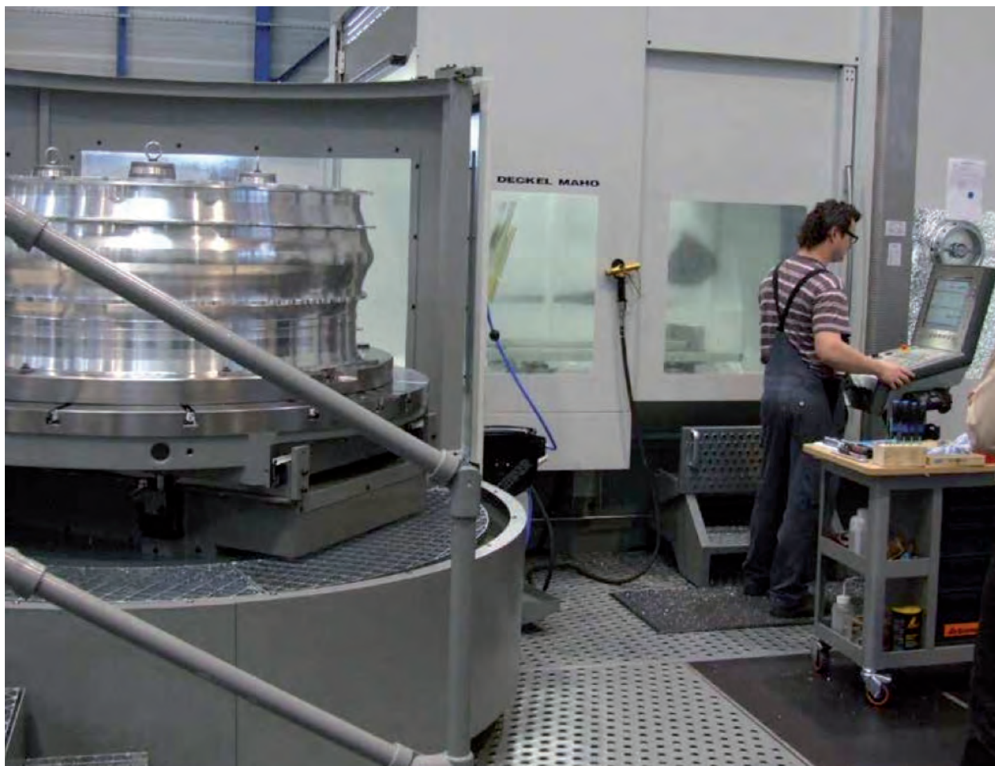
» Cellule de fabrication DMC 200 FD avec station de palettes
