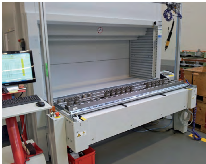
» Avec 494 emplacements, le stockeur rotatif assure la gestion de 32 références produit et des seuils de réassort pour les produits courants.
