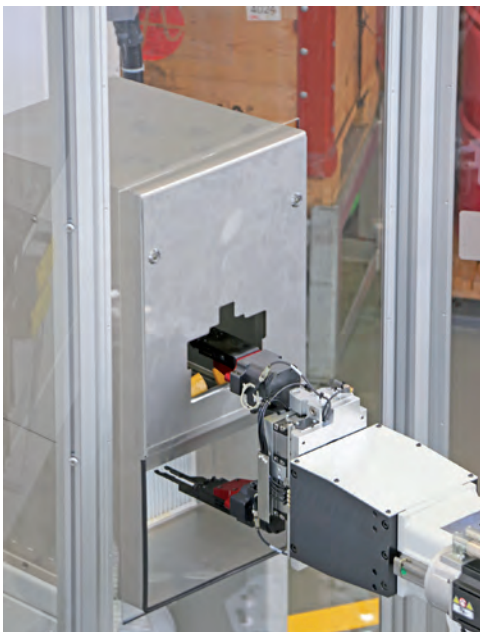
» Effectué en temps masqué, le nettoyage de la pièce permet de rendre immédiatement disponible celle-ci pour plus de réactivité.
