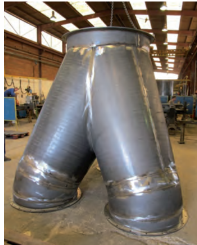
» Collecteur de gaz à trois entrées : l'enjeu de la qualité étant que la pièce puisse être montée sans retouches (« plug & play »)
