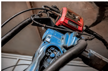
» L'unité de dévidoir compacte WF 25i R avec moteur d'entraînement dynamique trouve sa place sur chaque bras de robot et facilite nettement l'insertion du fil. (Source : Fronius)
