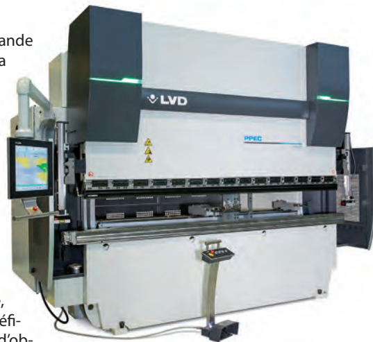
» Les voyants d'état LED indiquent l'état de fonctionnement de la machine pour une gestion plus efficace de l'atelier
