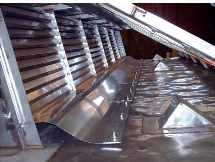
» Prototype de lanterneau pour une locomotive : inox, alu, acier, joints ; une pièce composite qui exige de multiples savoir-faire
