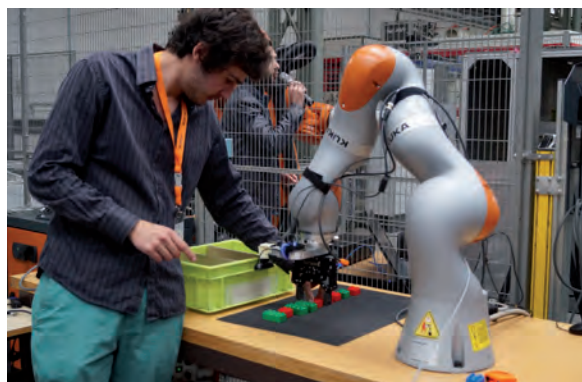
» Le machine learning renforcé pour le tri automatique des pièces sans programmation.
