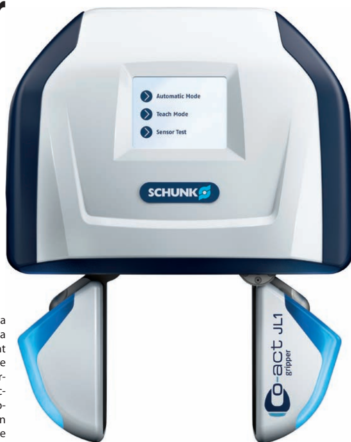
» Enveloppe souple – intérieur intelligent : la pince prototype Schunk Co-act JL1 marque une étape importante pour la collaboration homme/robot
