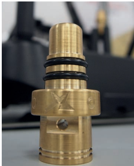
» Pièce contrôlée à l'aide de l'Equator (en fond)
