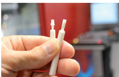
► La Kern Micro Ceramic permet des opérations d'usinage comme les alésages sur toute céramique dure
