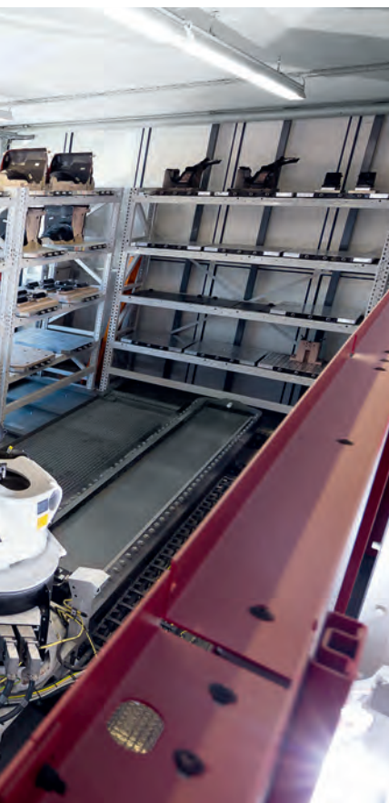
» Système de robot et de magasin de pièces RS 3 avec axe linéaire supplémentaire préparé pour 43 palettes.
