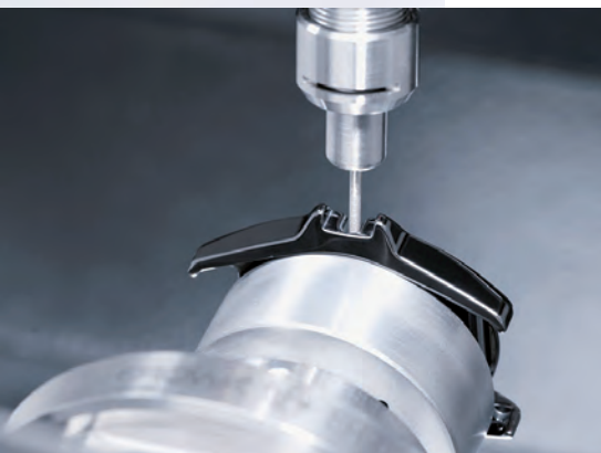
► Rectification d'un boîtier de montre en oxyde de zirconium noir sur une machine Ultrasonic
