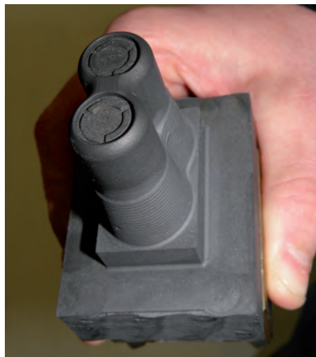
» Une électrode en graphite avec beaucoup de transitions 3D et des structures internes est contrôlée dans la machine en utilisant les produits m&h.
