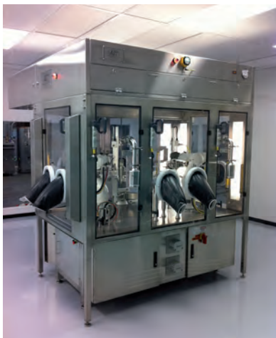
» Système RABS conforme à la norme de sécurité pour les robots ANSI/RIA R15.06-1999
