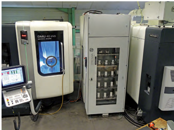
» Deux centres montés en opposition partagent un même magasin robotisé de 60 logements pièces
