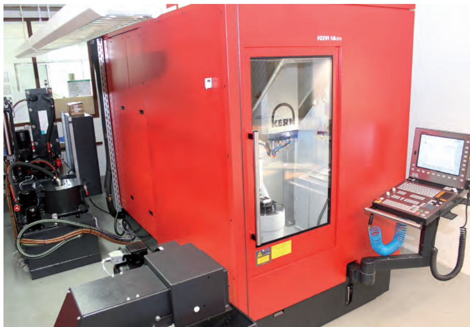
» La Kern Micro Ceramic a été mise au point pour un fraisage et meulage combiné, adapté à l'usinage en cinq axes simultanés de la céramique
