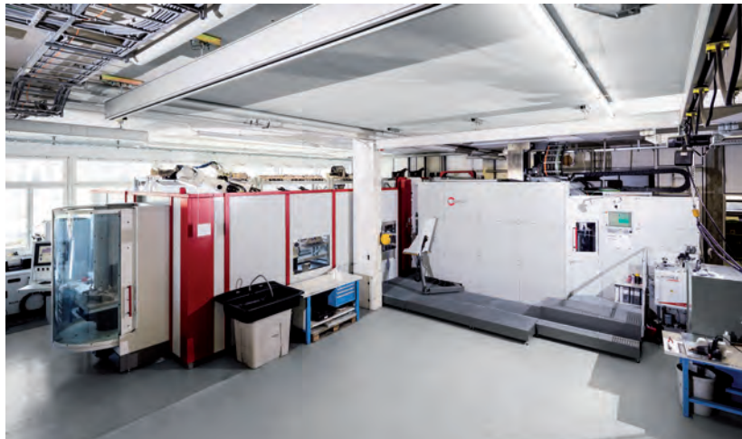
» À droite le centre d'usinage CNC 5 axes C 50 U, à gauche le système de robot et de magasin de pièces annexe RS 3
