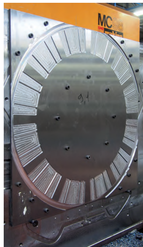
» Finition de poche pour un rotor de moteur de nouvelle génération
