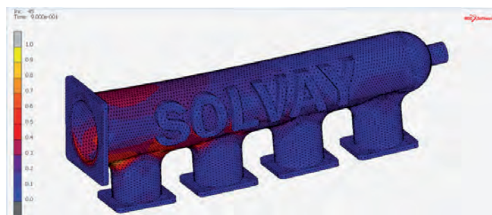
» Prévion de la répartition des signes de défaillance résultant de la pression d'éclatement d'un plenum Polimotor imprimé en matériau Sinterline (Solvay Engineering Plastics)
