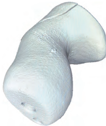
» Numérisation laser brute de prothèse d'oreille interne sur Shapegrabber
