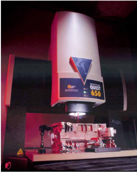
» Mesure avec laser TTL Telestra plus sur pièce mécanique
