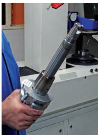
» Contre-fiche et outils coupants Mitsubishi Materials (fraise iMX et ARP)
