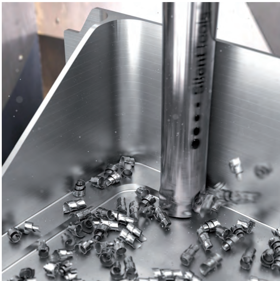
► La fraise CoroMill 390 est désormais disponible avec la technologie Silent Tools améliorée pour un usinage plus efficace de pièces en titane comme des supports moteurs.
