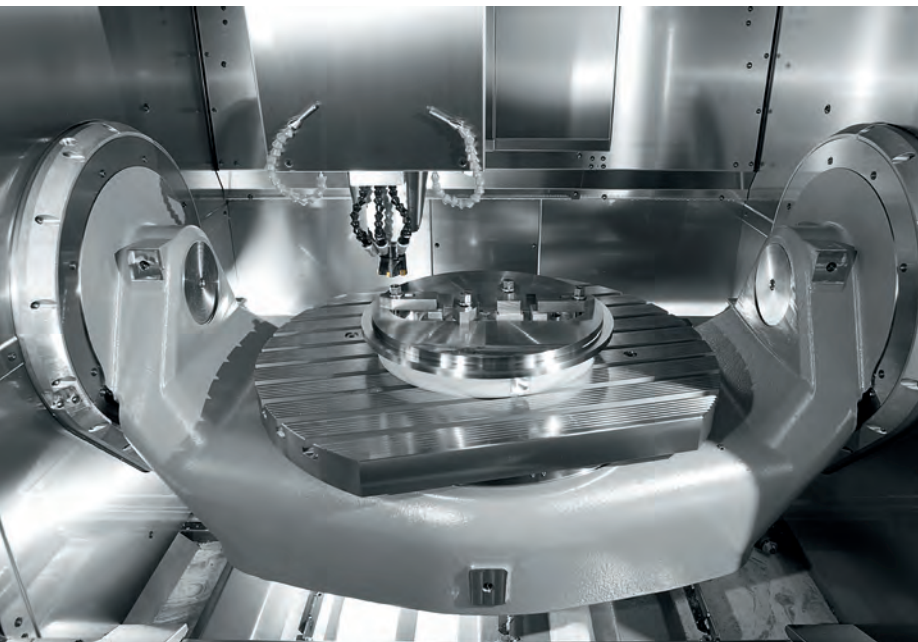
► Le centre d'usinage C 42 U, un espace de travail généreux avec sa table circulaire pivotante CN d'un diamètre de 800 x 630 mm (axes A et C) pour l'usinage complet et simultané à 5 axes/5 faces de divers composants pour l'accélérateur de particules
