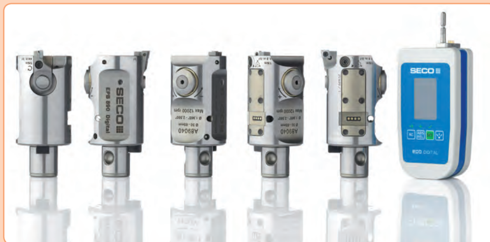
» Nouvelles têtes à aléser digitales EPB 890 : un afficheur digital pour régler un nombre illimité de têtes à aléser
