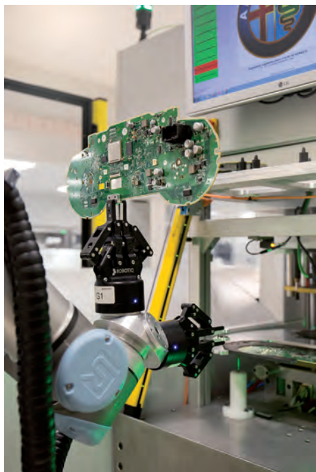
» Deux pinces permettent de manipuler les circuits intégrés de façon très rapide.
