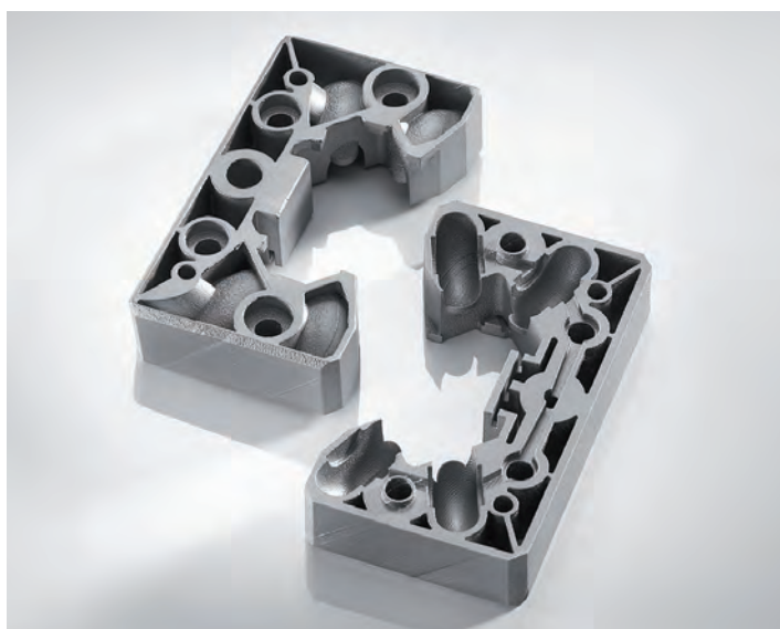
» Pièce conçue à partir d'un procédé de fabrication additive
