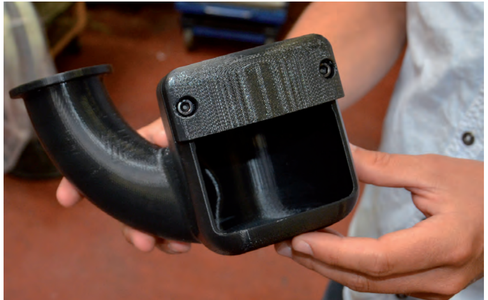
» Avec l'imprimante 3D Dimension 1200es, Mavic produit des logements de tuyaux d'aspiration en matériau thermoplastique ABS rigide en 8 heures
