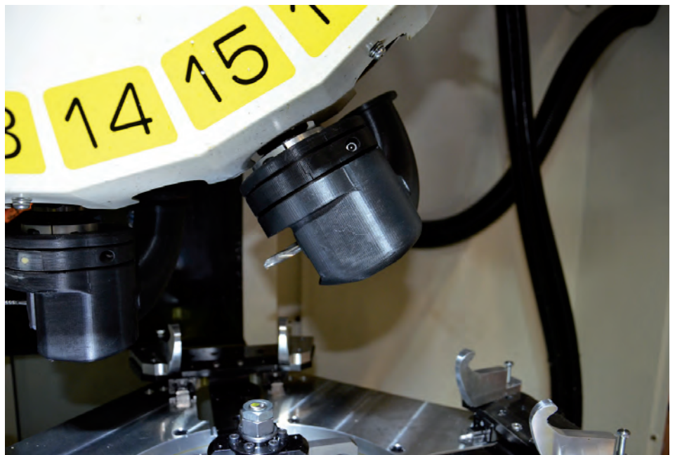
» Logement de tuyau d'aspiration imprimé en 3D (gauche et centre) installé sur les perceuses de la chaîne de production de Mavic
