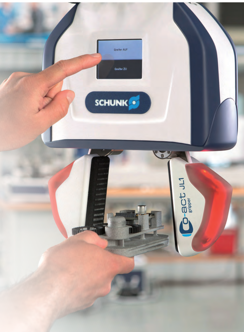
► Enveloppe souple – intérieur intelligent : la pince prototype SCHUNK Co-act JL1 marque une étape importante pour la collaboration homme/robot
