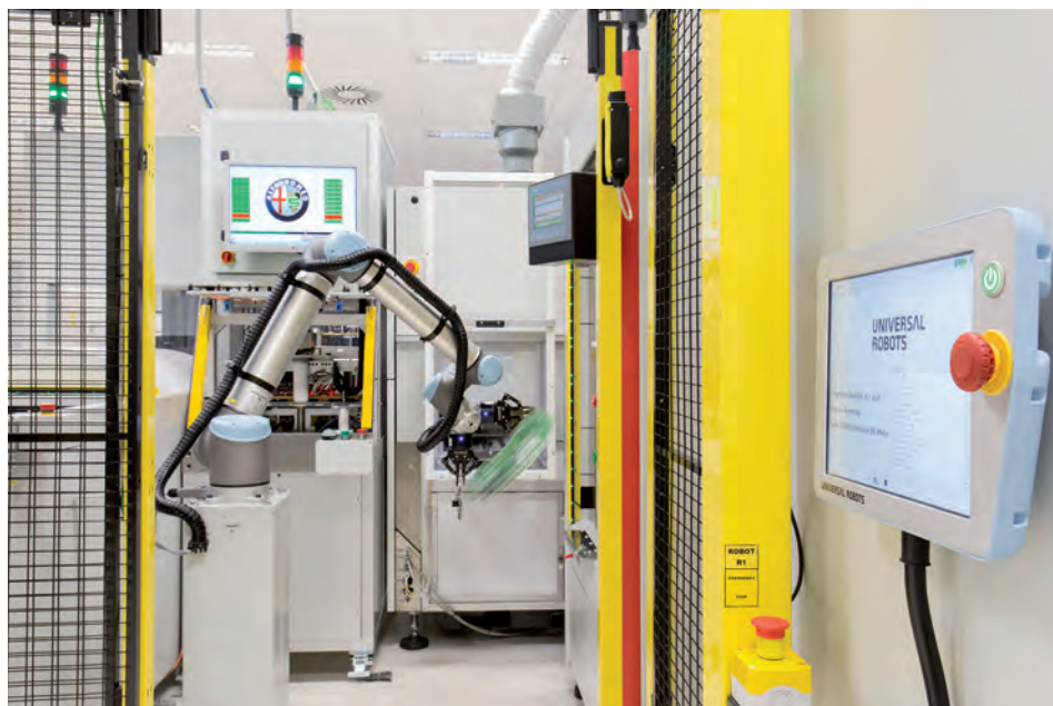
» Le robot est collaboratif et se détient à l'approche d'une personne dans la cellule.
