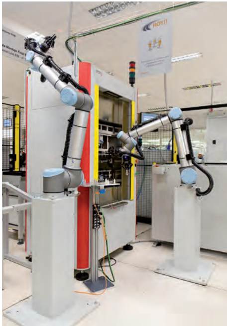
» Les robots occupent une fonction de surveillance de machines pour l'inspection des produits
