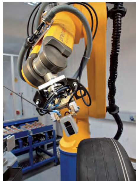
» La ligne automatisée comprend deux robots RX160 six axes
