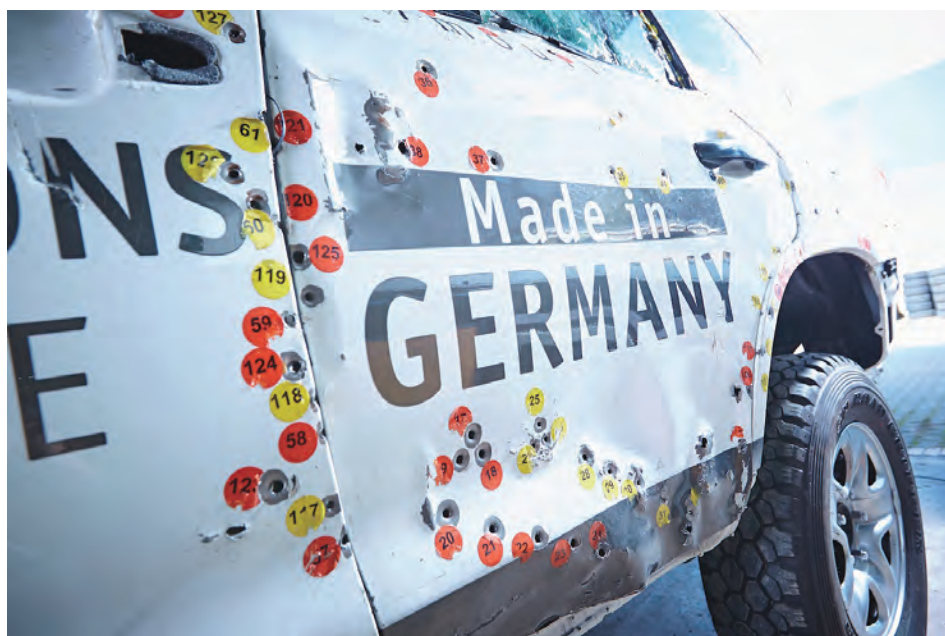
» Test de mitraille réussi : le FARO Edge ScanArm HD enregistre les cratères sur les éléments ayant subi des tirs, très précisément et sur différents matériaux
