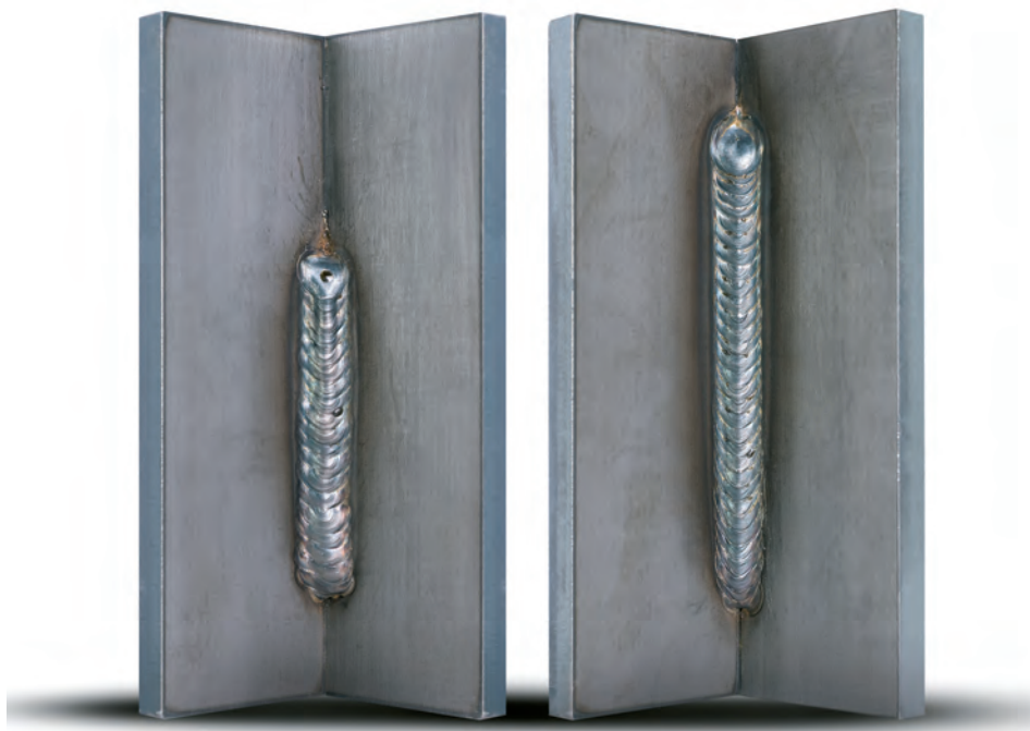
» En temps égal, les soudages montants peuvent être réalisés plus rapidement avec SpeedUp (à droite), en comparaison avec les techniques habituelles en « sapin » (à gauche)
