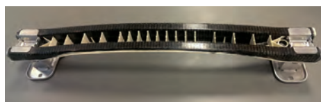
» Poutre de pare-chocs en composites produite à partir du procédé QSP
