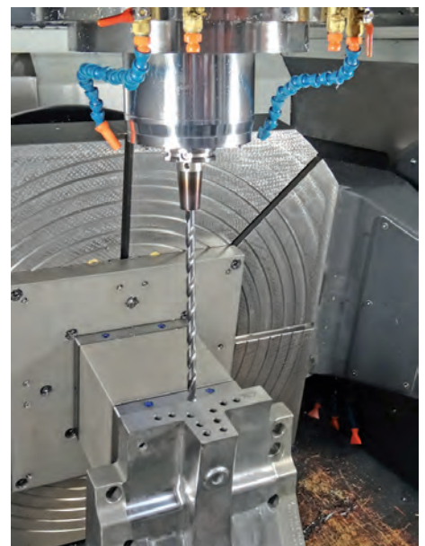
» Le foret MPS permet les perçages longs pour réaliser le circuit de refroidissement de l'ensemble poinçon-matrice
