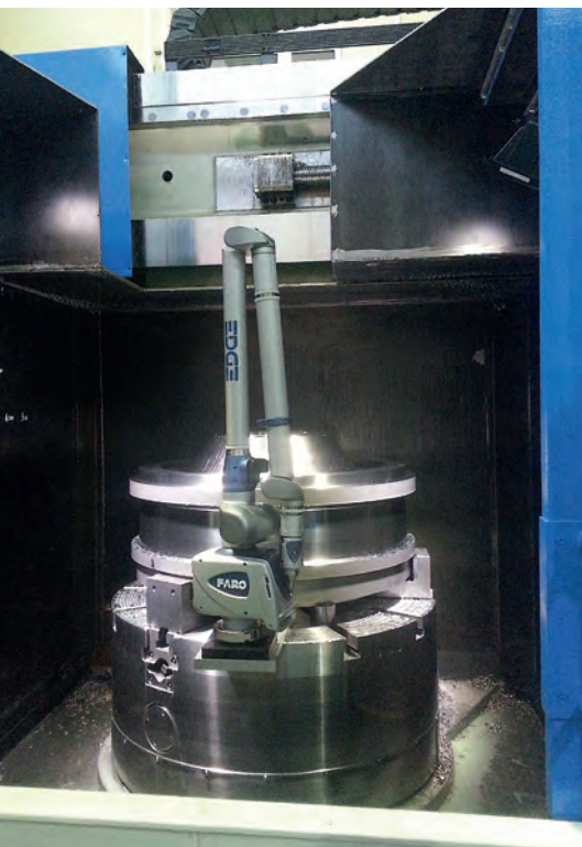
» Grâce à son scanner, le bras FARO ScanArm restitue en un temps record l'enveloppe numérique d'un moule ou d'une matrice
