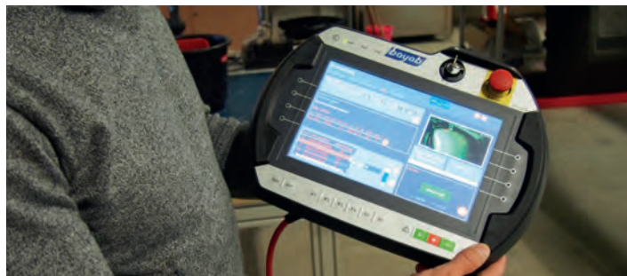
» Reply.5 peut être commandé au sol ou au pied de la pièce à réparer à partir d'une CN développée par Power Automation
