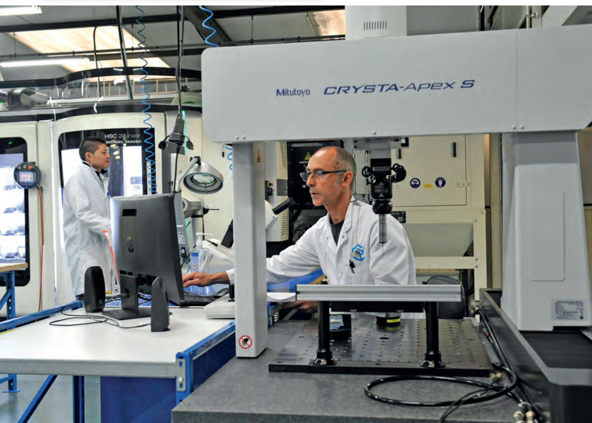
» La machine de mesure tridimensionnelle MITUTOYO - Crysta-Apex S au cœur de la production
