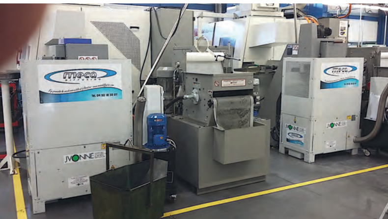
► Machines ECO Compact installées directement sous le convoyeur à copeaux des machines-outils
