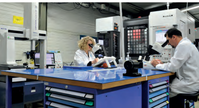
» Chaque pièce est ébavurée à la main avant contrôle
