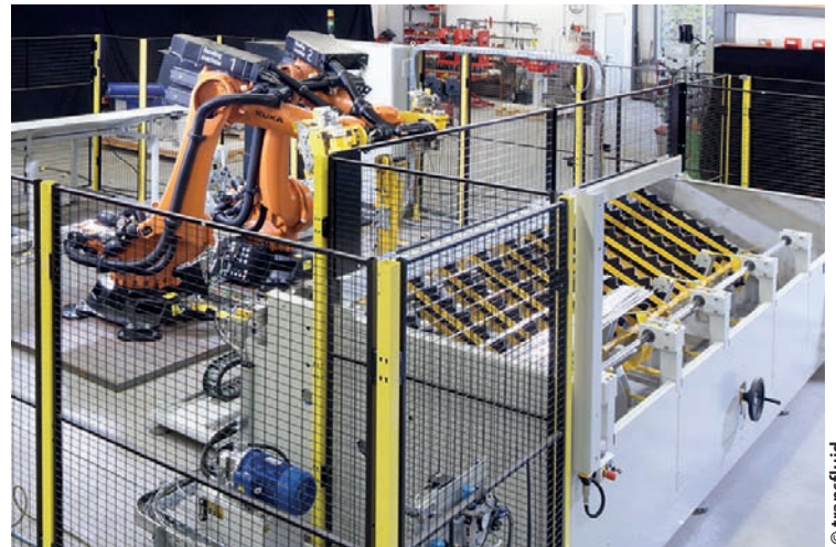
► Pour le traitement sans oscillation de longs tuyaux, le robot prend simplement la cintruse en main
