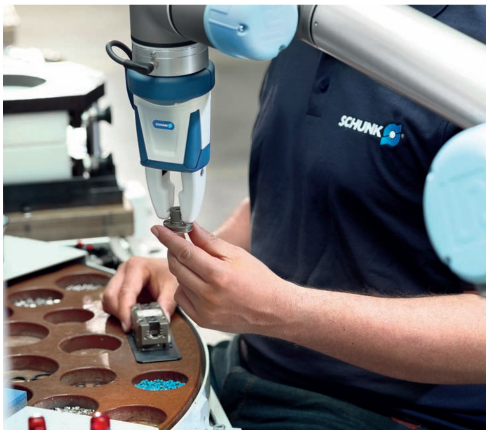
➤ La pince Co-act EGP-C de Schunk certifiée pour les applications collaboratives HRC simplifie l'assemblage de petits composants
