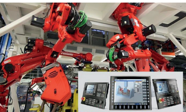
» Le bras robot Comau est piloté, donc programmé, directement par la CNC ; le contrôleur du robot n'est pas nécessaire
