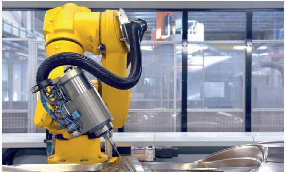
» Précision maximale requise : le Stäubli TX200 perce un trou pilote
