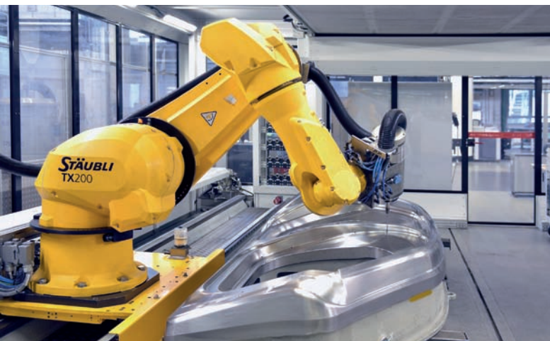
» Le centre d'usinage robotisé répond parfaitement aux attentes d'Audi en matière de perçage des événements
