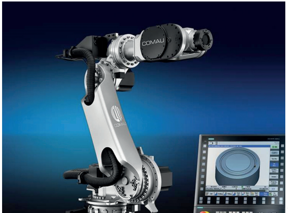
» Le bras Comau s'intègre en « plug and play » avec une connexion standardisée à la technologie Sinumerik
