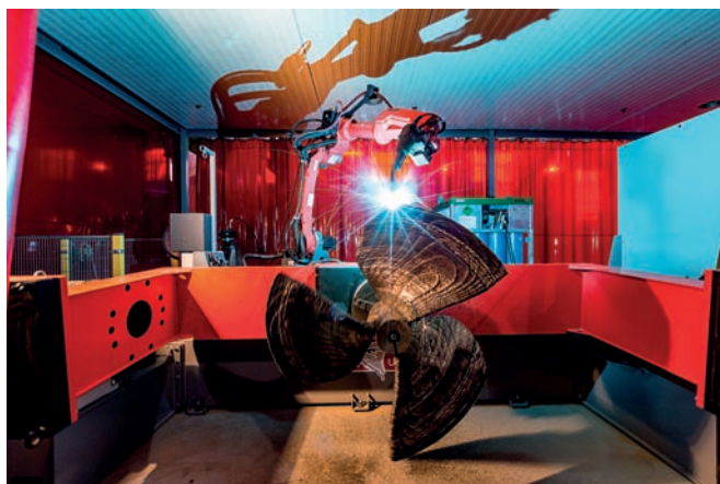
► Hélice de navire fabriquée par Autodesk et le laboratoire de fabrication additive du Port de Rotterdam (RamLab)
