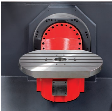
► Table 630 x 500 mm pour une masse maximale de 200 kg
