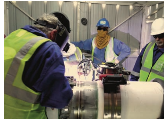
► Pour toutes les applications hygiéniques, les têtes de soudage fermées sont parfaitement adaptées
