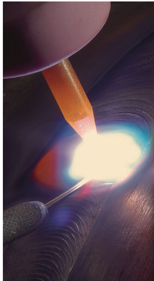
► Soudures parfaites lors de l'utilisation du procédé TIG orbital
