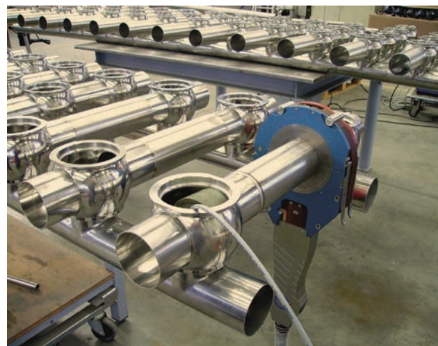
► Tubes à paroi épaisse soudés avec une préparation en joint étroit et une tête de soudage ouverte de type chariot
