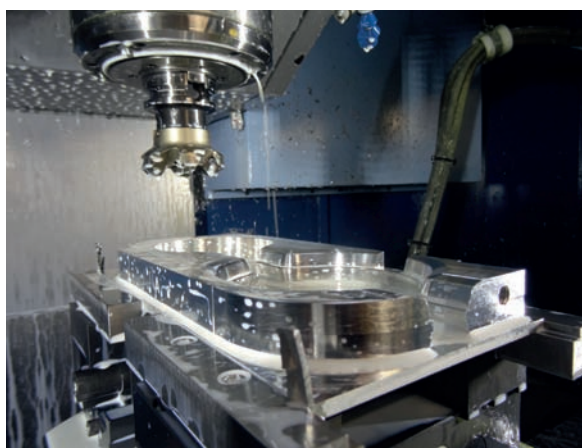
» Le B-cool 755 s'est montré performant pour la coupe des titanes et inconnels mais aussi pour l'usinage de l'aluminium
