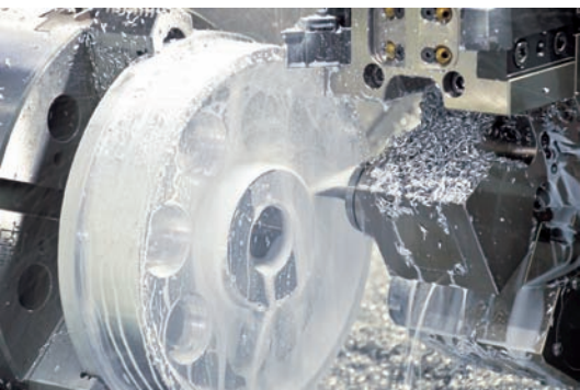
B-cool 755 a permis de réaliser 170 pièces en titane avec un même outil au lieu de vingt précédemment
