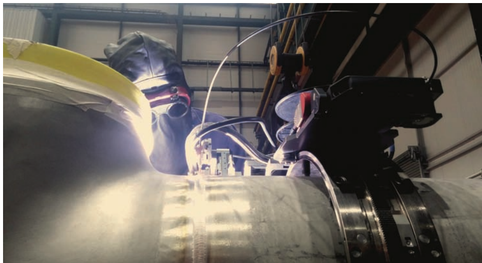
► Exemple d'application de la technique de soudage orbital dans le domaine du pétrole et du gaz, garantissant une soudure sans défaut
