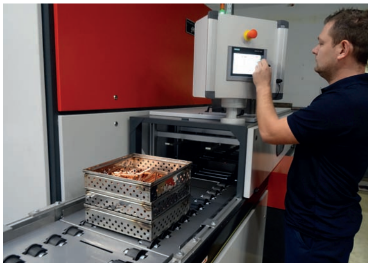
» Le dispositif de chargement automatisé permet de programmer une succession d'opérations de lavage comportant jusqu'à 3 paniers sur un même cycle.
