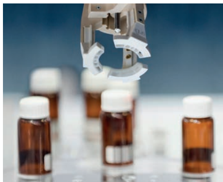
➤ Les pinces imprimées en 3D à partir de tribo-polymère iglidur I150 permettent de réduire les coûts de 85% et le temps de fabrication de 70% dans le secteur de l'emballage. (Source : igus)
