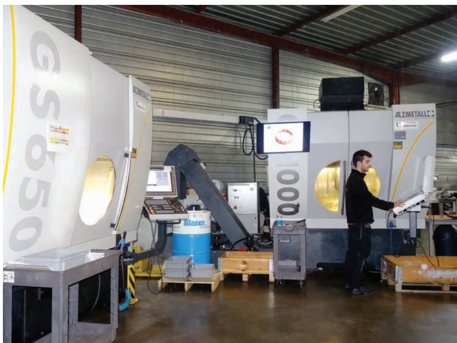
➤ La part dominante de la valeur ajoutée est réalisée sur des centres 5 axes ou des machines multi-axes pour l'aéronautique civile ou militaire
